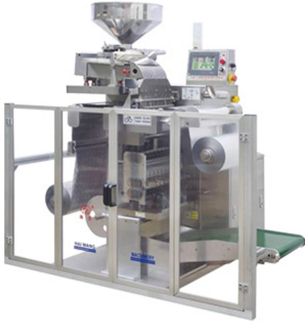
高速自动铝箔包装机适用于医药、保健品、化工、食品等行业的胶囊、片剂、糖果或丸剂块状物料的自动双铝箔热封包装，使包装物达到密封避光的要求。震动式加料、充填、纵横向压痕、打批号、裁切、收卷废边等全部自动完成，采用PLC控制，变频调速，人机界面操作，可任意调整冲裁（裁切）速度和行程距离。而且确保产品质量，是制药行业的理想设备，配备振动式整列加料机构，变频调速、行程可自由设定、充填、热封、撕线、打批号、裁切等工序自动完成、可达高速运行，同步准确无误，各项技术指标符合“GMP”规范要求。
