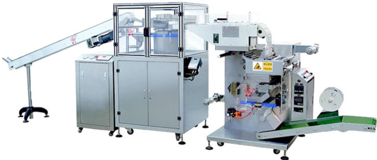
铝箔包装机具有结构先进，效率高，噪音低、操作方便等特点。采用变频调速，行程可任意设定，配振动式整列送料机构，附光电监测装置，自动计数，其充填、热封、切线、打批号、裁切等系列工序均属自动完成，可达高速运行。适用于医药行业之片剂、胶囊以及电子元器件等块状物品的包装，能起到良好的密封与避光作用。该机的上料部分改变了以往比较单一的下料方式，采取了依据不同的药品而采用不同的上料机，其停药机构采用了直动式，这与以往的摆动与抽拉上料方式相比具有结构简单停料放料准确的特点。包装功能：具有自动充填、封合、打印批号、纵横向易撕断裂线及横切功能，也可根据用户的要求实现自动对正色标的功能。嘉定区销售自动铝箔包装机直销价格海王机械为您提供优良、精湛、高速的铝箔包装机。
